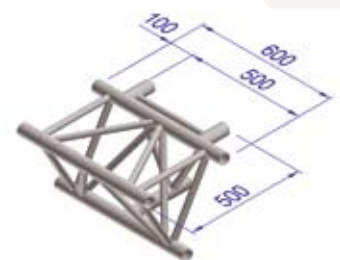
type description 017 T-joint horizontal
