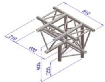
type description 020 T-joint + down
