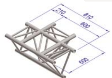
type description 017 T-joint horizontal
